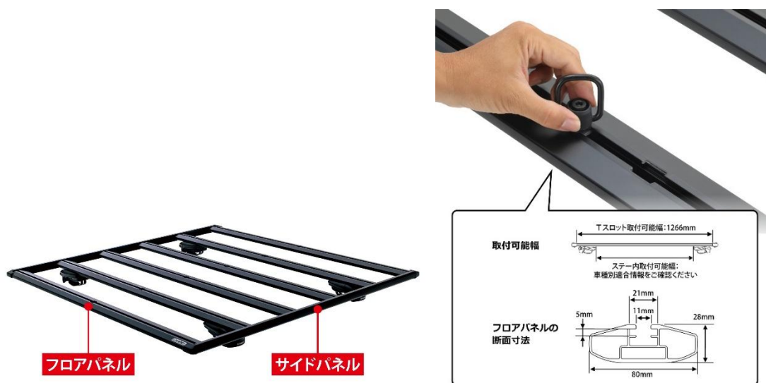
フロアパネルの溝を活用する T スロット取り付け
