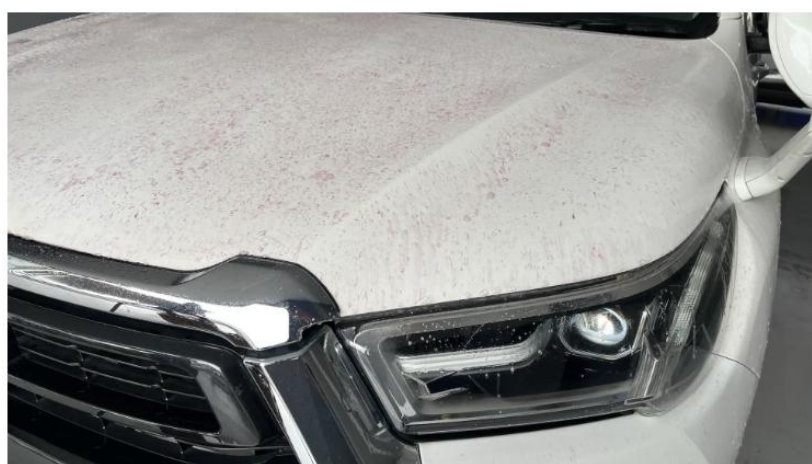
ハイラックス（令和3年式）のボディにスプレーした直後の様子。鉄粉の量に応じて、変色の度合いが変わります
