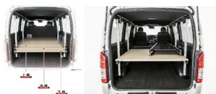
木材の床板を設置／上段にフロアバー設置：はしご等の長尺物の積載に便利
