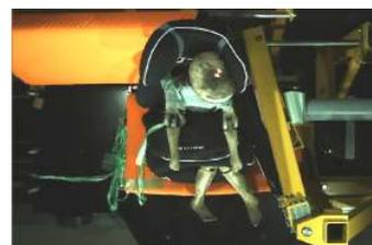
側突試験装置(平成24年5月稼動)
