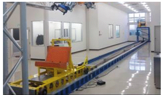
衝突試験機 (平成23年2月設置、3月稼動)
